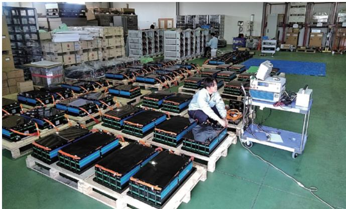
近年、低価格の海外製蓄電池システムが国内に流通されていますが、弊社はセル、モジュールレベルから検査を行い動作確認してから製造、組み立てをしています。また携帯通信網を利用した遠隔監視システムを導入して、蓄電池やパワコンの状態監視を行いトラブルの未然回避やアップグレードに対応しています。
